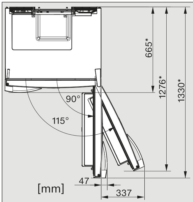
\* Размер без смонтированных проставок для соблюдения расстояния от стены. При использовании прилагаемых проставок глубина прибора увеличивается на 35 мм.
