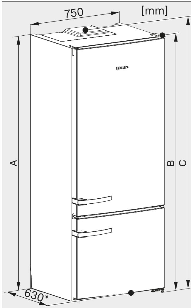
\* Размер без смонтированных приставок для соблюдения расстояния от стены. При использовании прилагаемых приставок глубина прибора увеличивается на 35 мм.
