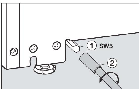
В случае необходимости выровняйте дополнительно задние регулируемые ножки прибора, используя передние регулировочные оси ① (находятся рядом с передними регулируемыми ножками).
